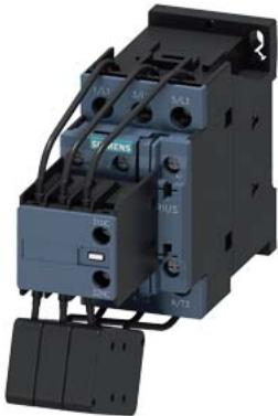
contactor para condensador, AC-6b 16,7 kVAr, /400 V, tripolar, 220 V AC, 50 Hz/240 V, 60 Hz, contactos auxiliares: 1 NA + 2 NC, borne de tornillo, tamaño: S0
